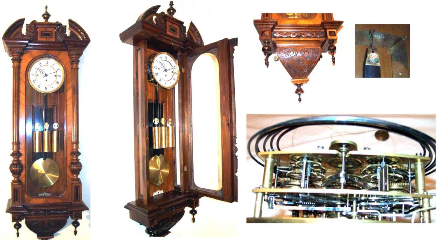
Uhrwerke mit Trägerplatte, Pendel-Aufhängung, Gewichts-Aufhängung und Schlagwerk
