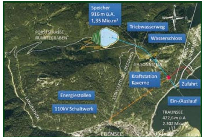
Für das Pumpspeicherkraftwerk Ebensee laufen die Vorbereitungen der Umweltverträglichkeitsprüfung auf Hochtouren. In der Planübersicht die Details zur geplanten Kraftwerksanlage.
